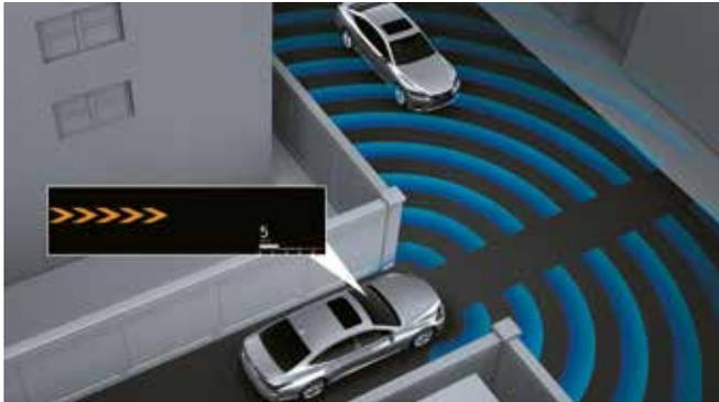
arrive de la droite ou de la gauche. L'alerte apparaît alors dans l'affichage tête haute. Si le conducteur s'engage dans l'intersection malgré l'avertissement d'une approche sur la voie transversale, une alarme sonore retentit doublée d'une alerte sur l'écran multi-informations.
